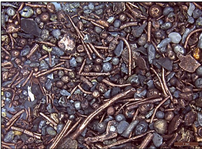
Abb. 6: Intakte Kupferdrähte im Gemisch mit geschmolzenen Kupferdrähten, die sich zu Kügelchen zusammengezogen haben.
