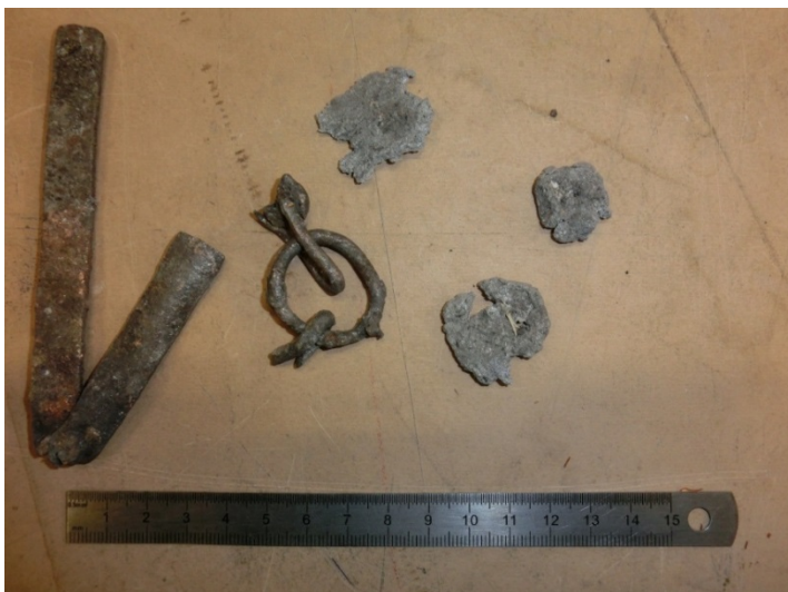
Abbildung 3: links: Flachgedrückte Metallteile, rechts: Schadensbild Grabenstampfer
