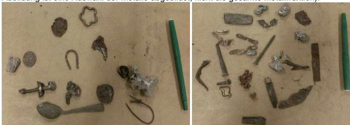
Abbildung 7: Auswahl flachgedrückter Metalle aus Vibroplattenversuch, links: 16-32 mm, rechts: 8-16 mm
