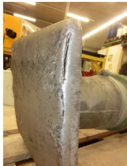
Abbildung 3: links: Flachgedrückte Metallteile, rechts: Schadensbild Grabenstampfer
