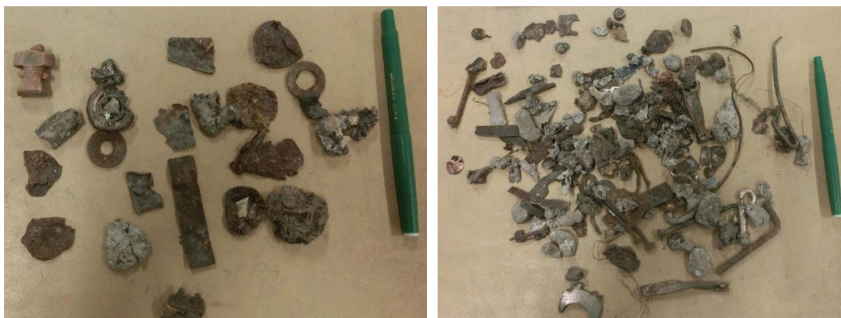
Abbildung 6: flachgedrückte Metalle aus Walzenversuch, links: 16-32 mm, rechts: 8-16 mm
