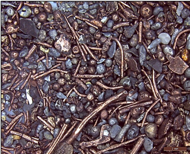
Abb. 6: Intakte Kupferdrähte im Gemisch mit geschmolzenen Kupferdrähten, die sich zu Kügelchen zusammengezogen haben.
