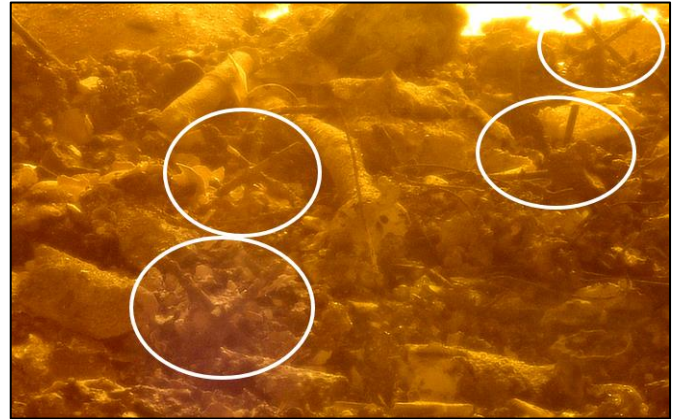
Abb. 4: Blick durch das Ofenfenster auf Prüfkörper der Serie B, die auf dem Kehrriechtbett aufliegen.
