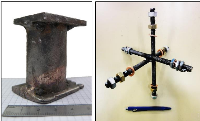
Abb. 2: (links) Prüfkörper Serie A: Probenbehälter in welchem Indikatormetalle mit bekannten Schmelzpunkten in Sand eingelagert waren (Photo: Probenbehälter nach Rückgewinnung aus der Schlacke).
